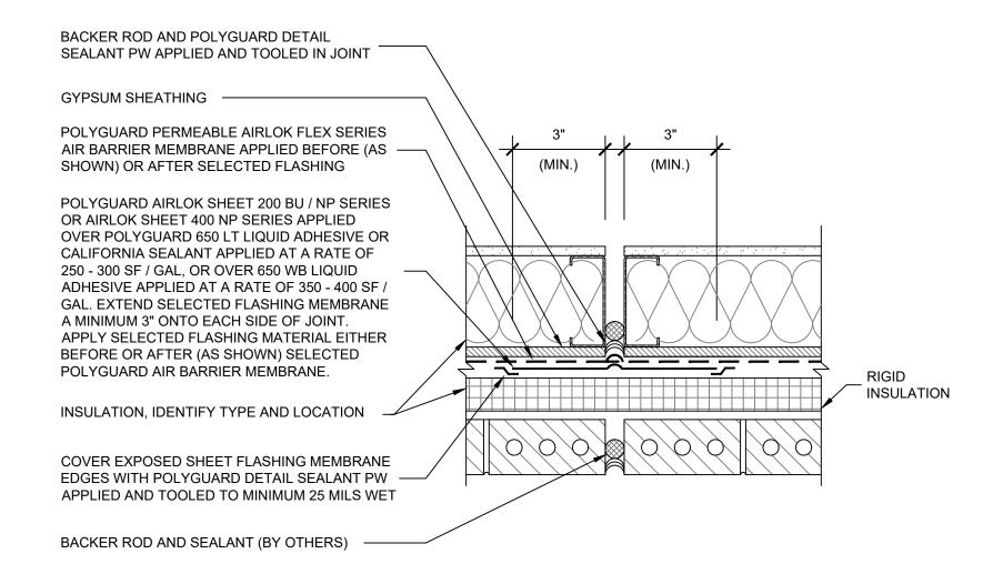
11 **AFFP**  PLAN @ FRAMED BACKING WALL / MASONRY VENEER - EXPANSION / CONTROL JOINT
