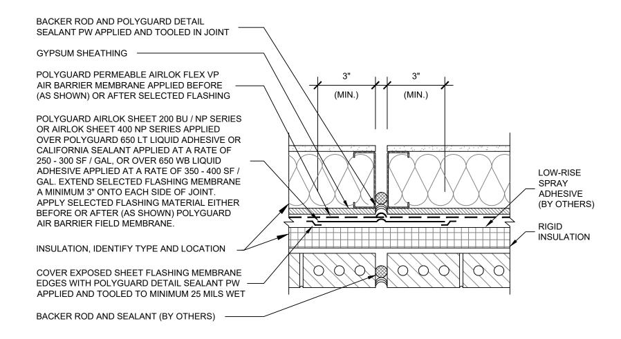
11 **AFFP**  PLAN @ FRAMED BACKING WALL / MASONRY VENEER - EXPANSION / CONTROL JOINT
