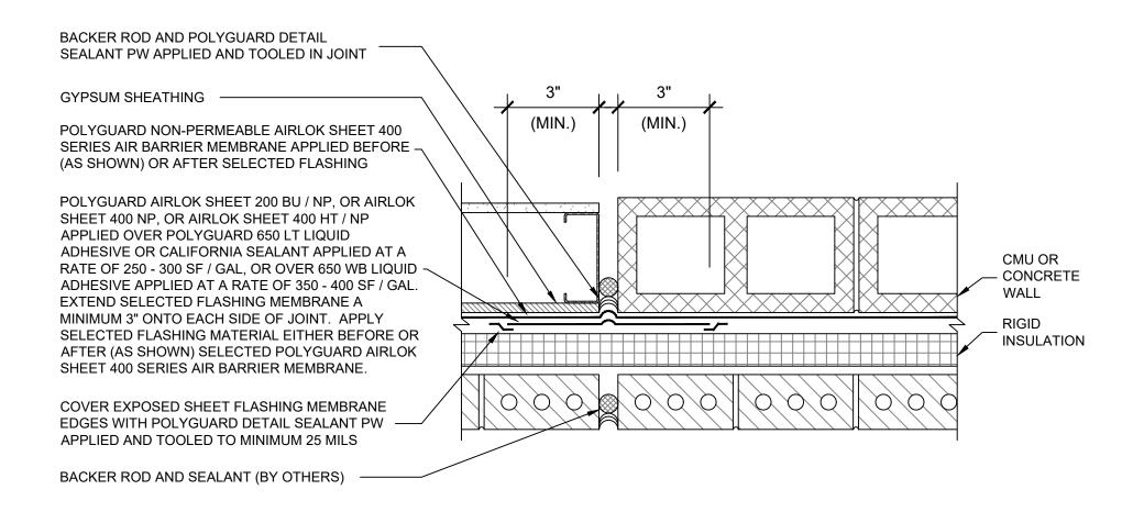
10 ASANP PLAN @ FRAMED BACKING WALL / MASONRY VENEER - TRANSITION JOINT
