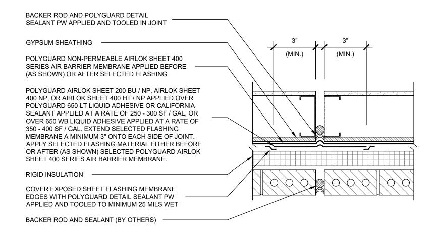
PLAN @ FRAMED BACKING WALL / MASONRY VENEER - EXPANSION / CONTROL JOINT
