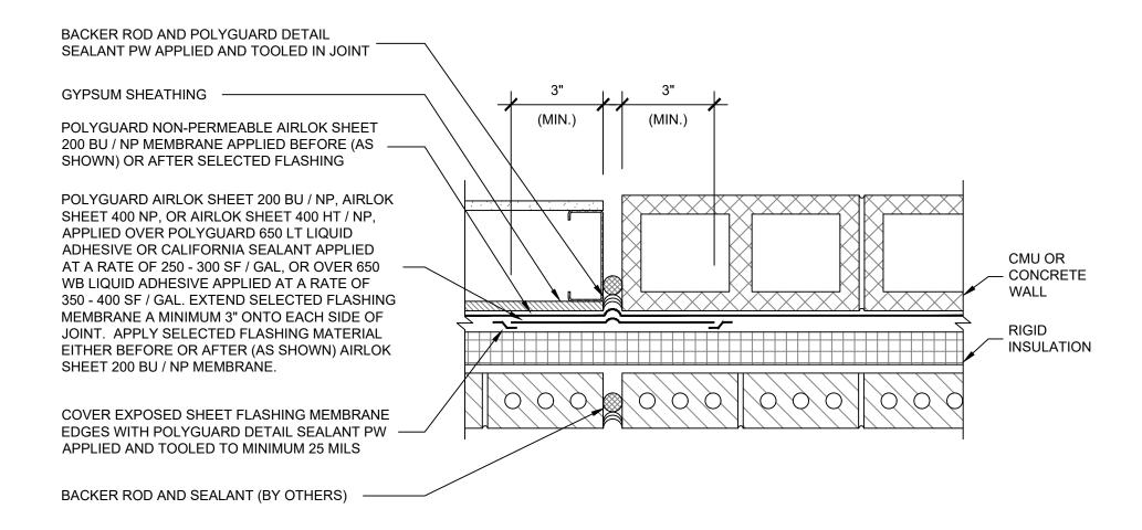
10 ASBNP PLAN @ FRAMED BACKING WALL / MASONRY VENEER - TRANSITION JOINT
