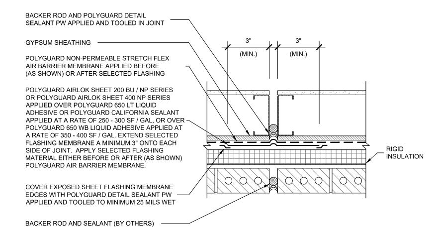
11 SEAG PLAN @ FRAMED BACKING WALL / MASONRY FINISH - EXPANSION / CONTROL JOINT
