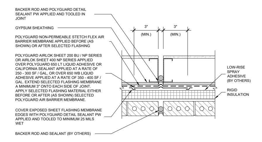
11 SEAG PLAN @ FRAMED BACKING WALL / MASONRY VENEER - EXPANSION / CONTROL JOINT
