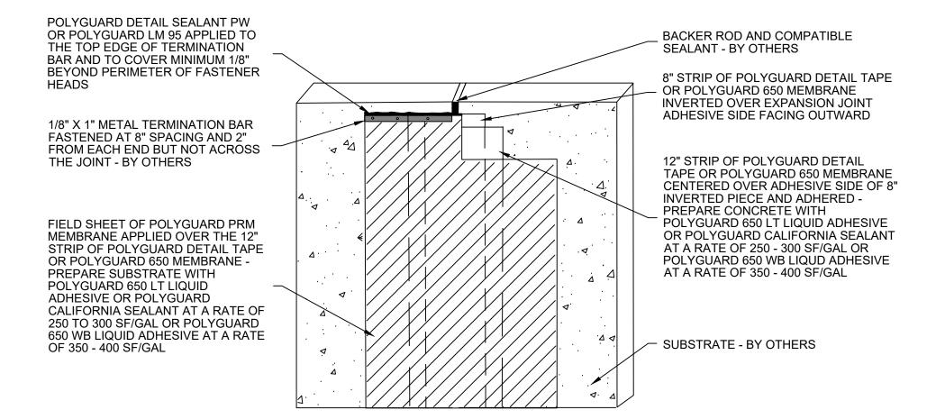
SECTION @ VERTICAL WALL EXPANSION JOINT COVER
