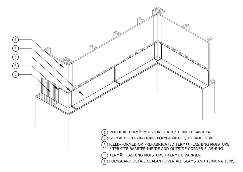
TERM® FLASHING MOISTURE / TERMITE BARRIER IN CAVITY WALL - INSTALLATION SEQUENCE
